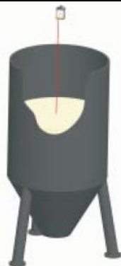
Niveaumessung in Silos
